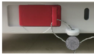
Bloqueado con cable de sellado
